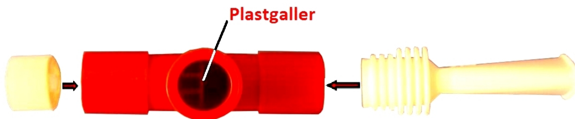
Bild 12. Montering av backventil och munstycke i förhållande T-styckets plastgaller.
